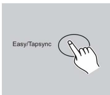
1. Um in den EASY Modus zu gelangen, halten Sie die Taste EASY/TAPSYNC für ca. 2-3 Sekunden lang gedrückt. Im Display steht nun der Text „EASY“.
