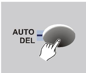
3. Halten Sie die AUTO/DEL Taste gedrückt und Drücken Sie gleichzeitig die BLACKOUT Taste, um die Blackout Funktion zurückzusetzen.
