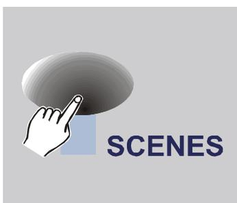
6. Benutzen Sie die Szenen Tasten, um die Kanäle einzeln an- oder auszuschalten. Im Display wird der jeweilige Zustand kurz mit „Channel xy: On“ oder „Channel xy: Off“ angezeigt. „On“ bedeutet, dass dieser Kanal bei den gewählten Scannern überschrieben wird.
