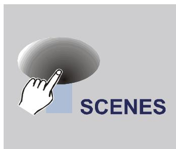
4. Benutzen Sie die Szenen Tasten, um die Kanäle einzeln an- oder auszuschalten. Im Display wird der jeweilige Zustand kurz mit „Channel Inverted“ oder „Channel Normal“ angezeigt.
