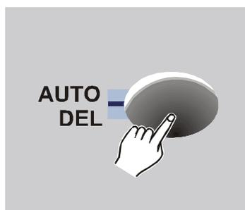
3. Halten Sie die AUTO/DEL Taste gedrückt und Drücken Sie gleichzeitig die Overlay Szenentaste, die Sie löschen möchten.
