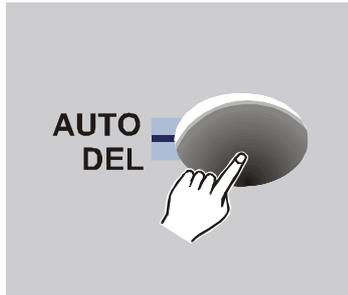
5. Drücken Sie die AUTO/DEL Taste um den angezeigten Chaserschritt zu löschen. Als Speicherbestätigung erhalten Sie die Meldung „Step Deleted“.
